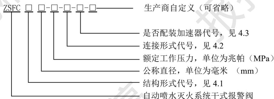
示例：ZSFC J 100-1.2-G-A 表示配装加速器，连接形式为沟槽连接，额定工作压力为 1.2 MPa，公称直径为 100 mm 的机械式干式报警阀。
